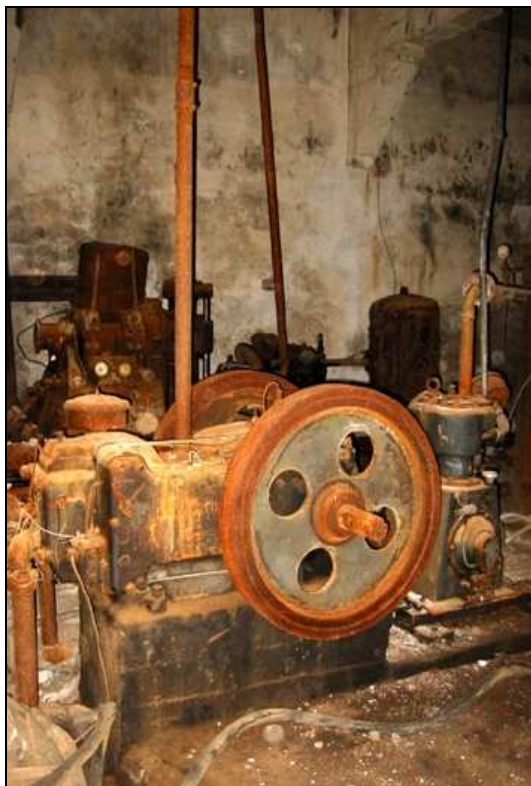
FIG. 4 Motor principal, de pistón horizontal, con el que se impulsa el resto de la maquinaria de un pozo; mediante transmisión por correas. La Lechucilla, Vega de San Mateo (Gran Canaria). 2003
