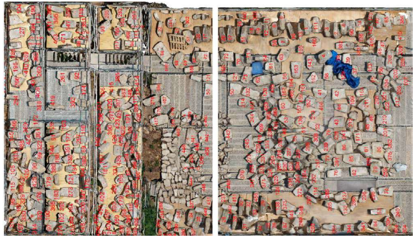
Fig. 49 y 50: Imágenes de los acopios numerados de las piezas recuperadas sobre las plataformas andamiadas.
