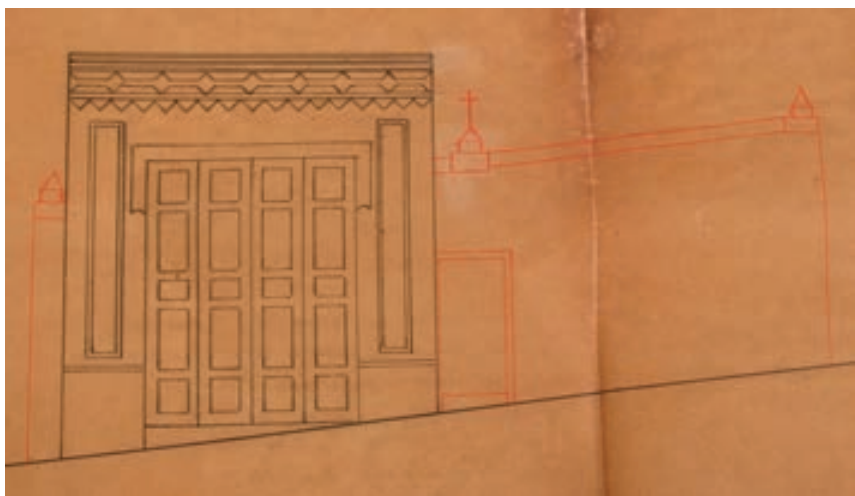
Alzado actual y reformado. Plano para la construcción de un garaje tras demolerse la tapia (en color rojo en el plano original) en San José, número 7 (hoy 30), propiedad de Juan Cabrera Martín, 1924. [AMSCP]
