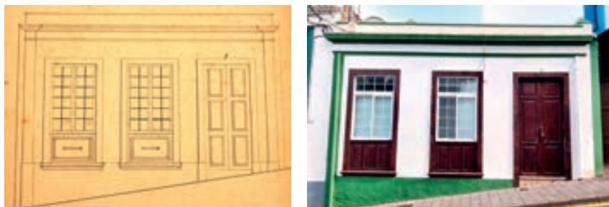
Izquierda, proyecto de reforma de fachada de San José, número 5, hoy 32. Alzado. Maestro de obras Felipe de Paz Pérez, 1880. [AMSCP]. Derecha, estado actual
