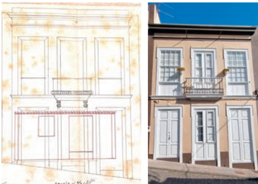
Izquierda, alzado actual y reformado del maestro de obras Atilio Duque Batista. En rojo, el inmueble original cubierto con tejas; en negro, reedificado, 1905. [AMSCP]. Derecha, el inmueble en la actualidad
