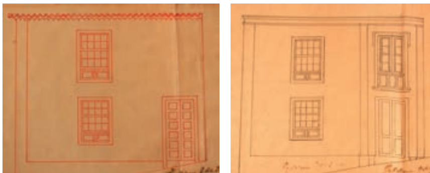
Alzado de San José, número 3 (hoy 34), en 1927, antes y después de la apertura de un hueco en su fachada. [AMSCP]
