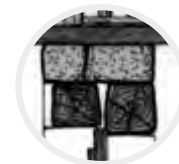
Lumieira de oco para corte, resolto con dúas filas de vigas de madeira
