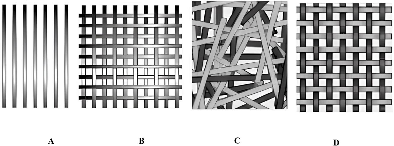
**Figura 1.** Orientación de las fibras. **A.** Unidireccional **B.** Bidireccional **C.** Aleatorias **D.** Tejidas
