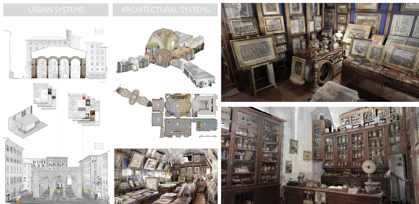
Figura 3. A la izquierda: imágenes ejemplares de las nubes de puntos 3D establecidas mediante escaneo láser de la Plaza del Mercado Nuevo y de algunas tiendas del centro histórico. A la derecha: imágenes detalladas de los interiores de las nubes de puntos a color de dos características tiendas. Imagen de los autores.
