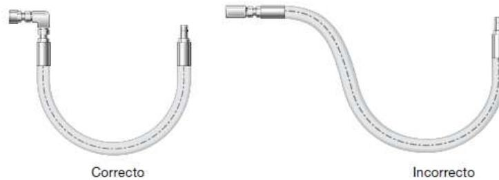
**Figura 3-3: Accesorios para el esfuerzo de la manguera de silicona**
