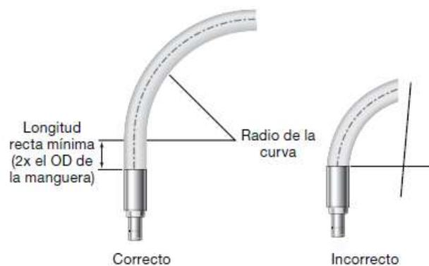
**Figura 1-3: Radio de la curva de la manguera**
