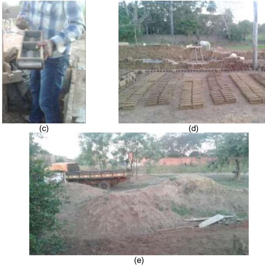
**Figura 9 – Olaria que ainda está em funcionamento. (a) instrumento à tração animal para homogeneização da matéria prima, (b) local de mistura manual e adição de água à argila, (c) forma ou molde para fabricação dos tijolos, (d) tijolos colocados para “cura”, e (e) argila fornecida pela CESP.**
