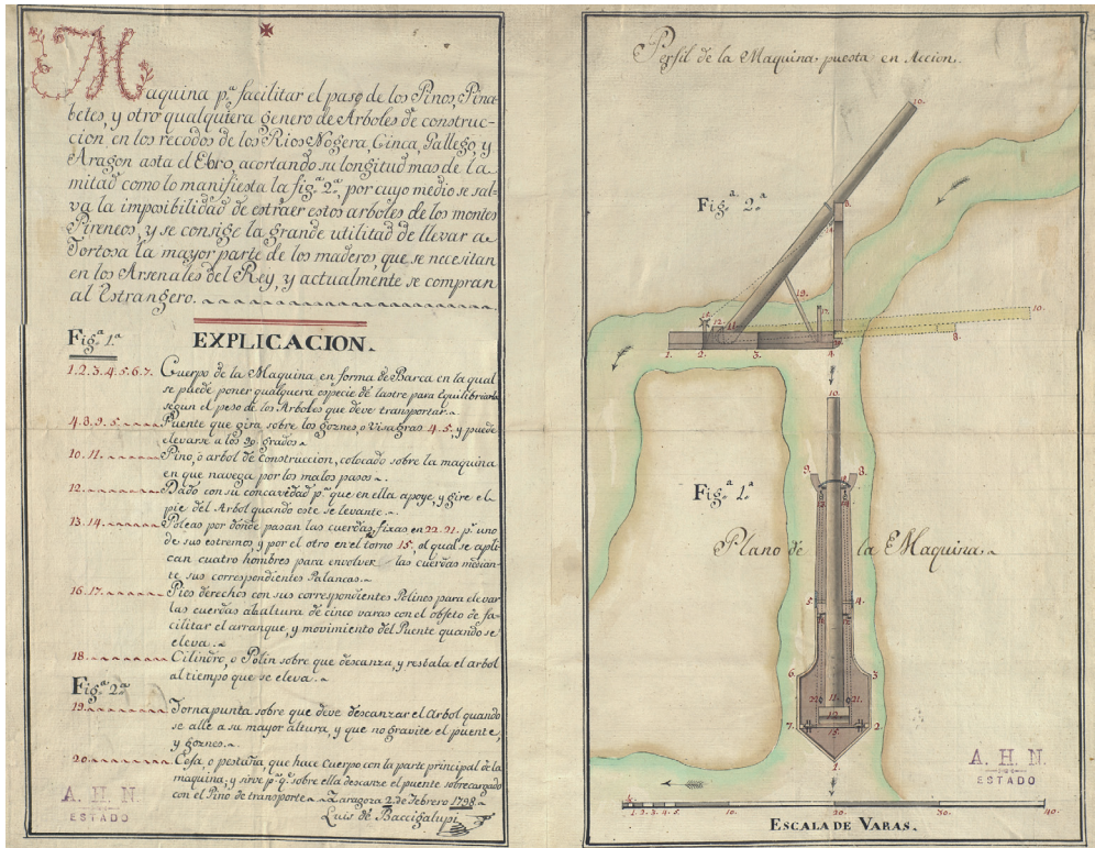
Idea de Luis de Baccigalupi para transportar mástiles por los recodos del Pirineo. (Archivo Histórico Nacional)
