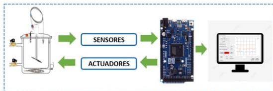
Fig. 9. Implementación de la automatización del reactor.
