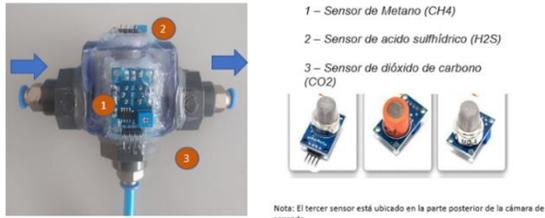
Fig. 8. Sistema de medición de calidad de biogás.
