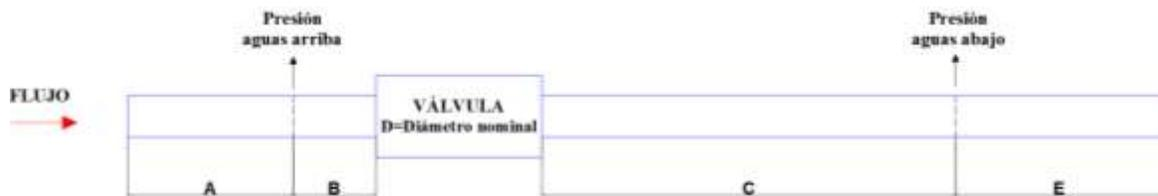
Figura 3. Esquema de ensayos en válvulas
