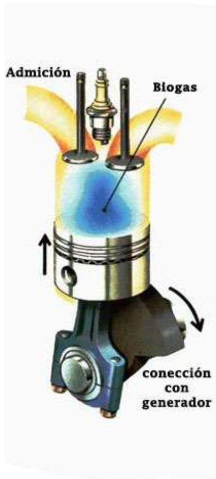
**Figura 1.9. Interior del motor de generador por biogás**
