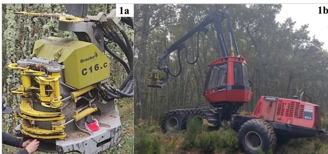
Fotografía 1a y 1b. Cabezal Bracke C16.c y taladora-apiladora multiárbol.
