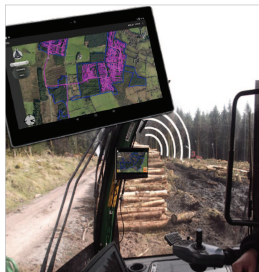
Figura 10. Sistema de geolocalización y control de la producción, permite evitar áreas sensibles.
