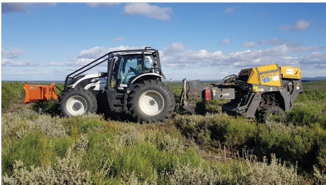
Figura 17. Desbrozadora — empacadora de biomasa BioBaler.
