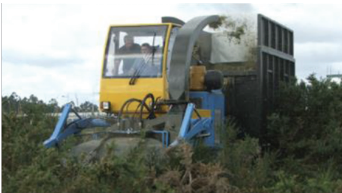
Figura 16. Desbrozadora — trituradora — recolectora de biomasa RetraBio.
