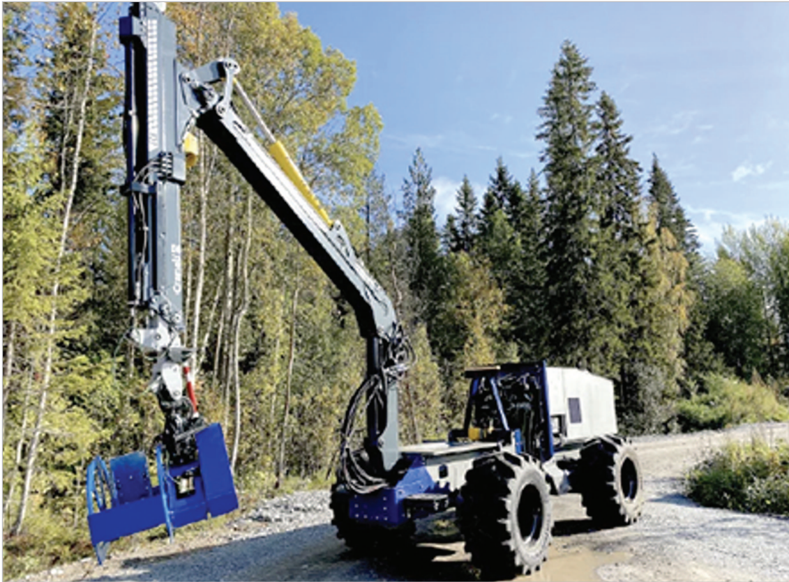
Figura 22. Prototipo de cosechadora forestal controlada a distancia.
