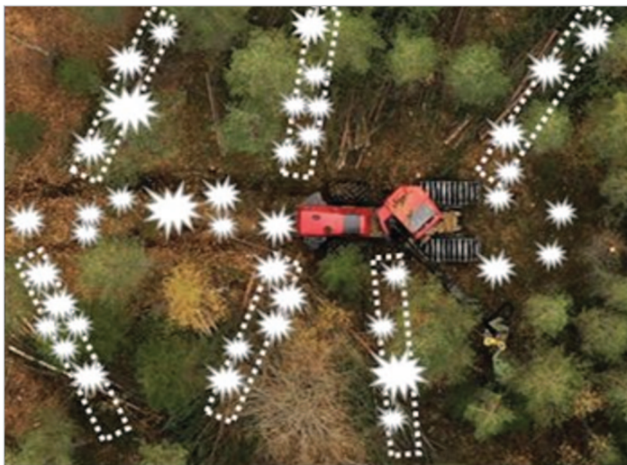
Figura 14. Método de clara semisistemática “boom corridor”- Fuente: De la Cruz, 2020
