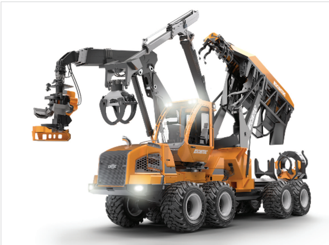
Figura 21. Prototipo de máquina con dos grúas y una unidad compresora, basada en la automatización parcial.
