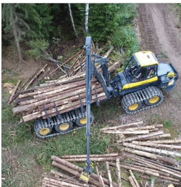
Figura 9. Autocargador con diez neumáticos de baja presión más semiorugas para controlar daños.
