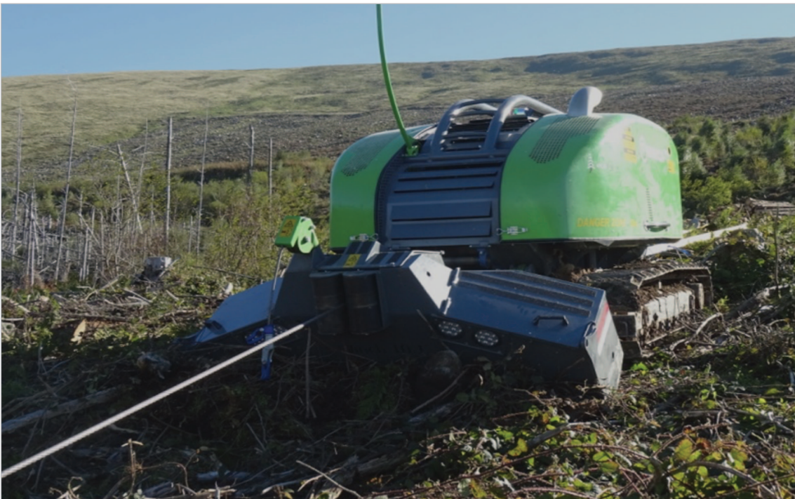
Figura 12. Cabrestante controlado a distancia para descolgar maquinaria en fuertes pendientes.
