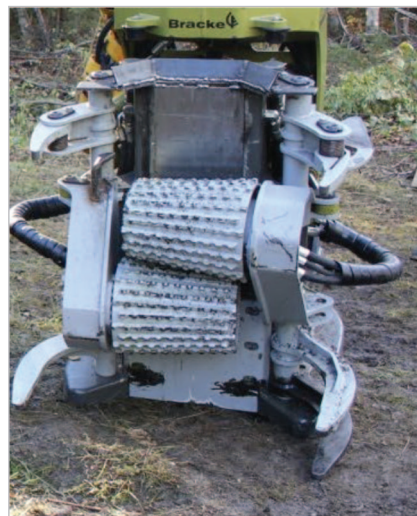
Figura 15. Prototipo de cabezal multitalador compresor Bracke. Fuente: Bregström, 2019
