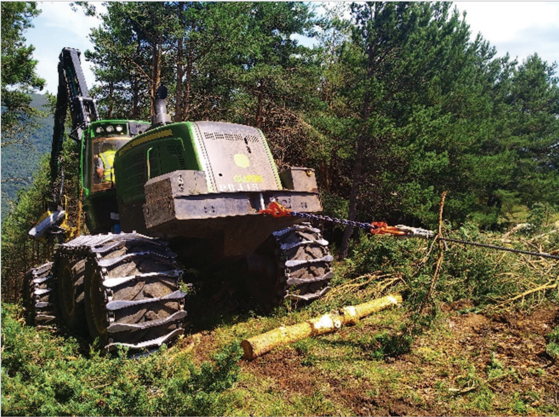
Figura 11. Maquinaria forestal suspendida de un cable en zona de fuerte pendiente.
