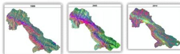
Es necesario aclarar que la presente técnica utilizada (ACP) permite obtener una síntesis de la información obtenida en la imagen compuesta por diferentes bandas, generando como resultado en una primera instancia colores definidos por el sistema (Figura 6), siendo convenientes cambiar dichos colores por otros que permitan realizar un mejor análisis en las imágenes.
