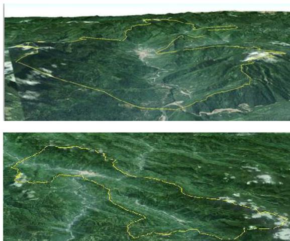
*Geo-referenciación.* Se realizó mediante los datos obtenidos con GPS (tipo vectorial), con el que se procedió a la ubicación de puntos de control (homólogos) para la rectificación de las imágenes satelitales. Todo ello se realizó en el software ArcGIS.
