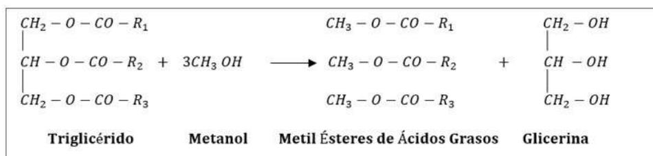
Fig. 1. Reacción global de la transesterificación para la obtención de glicerina [12]
