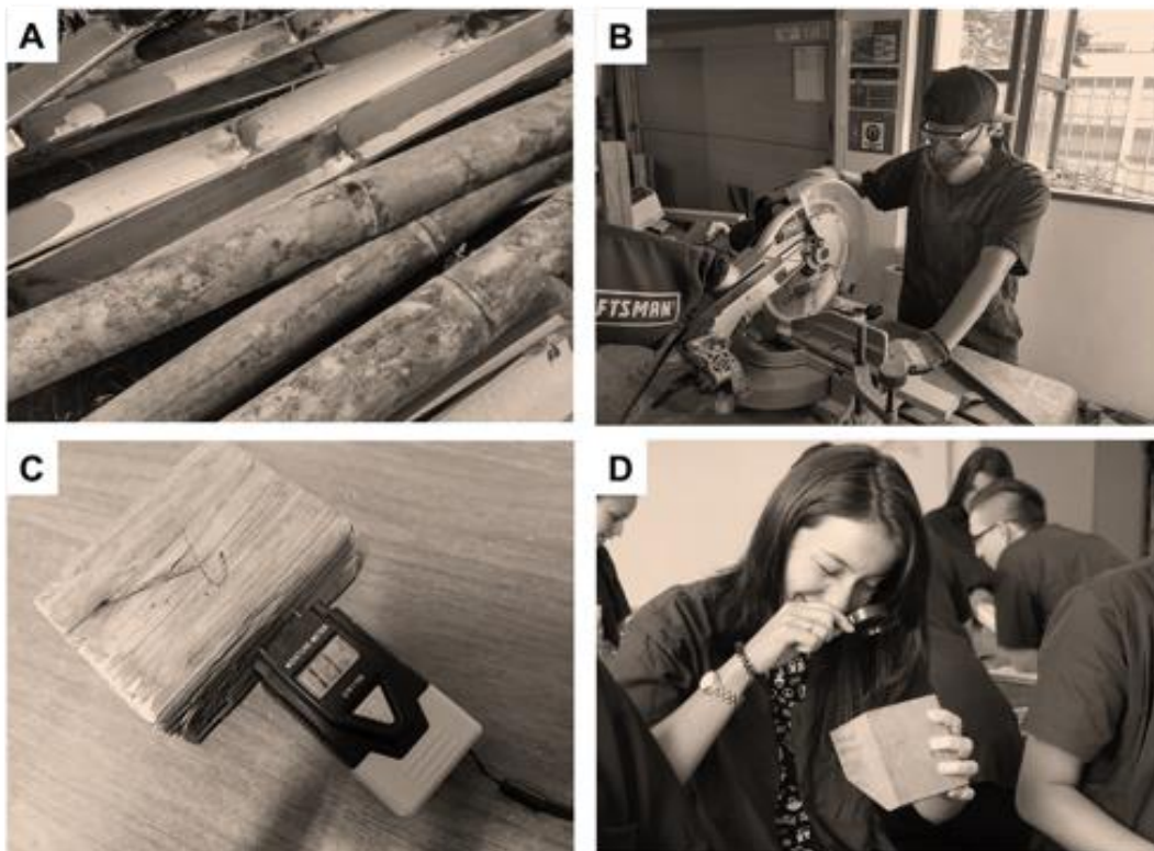
Figura 5. Análisis de guadua y madera: A) Guadua, B) Corte de madera, C) Medición humedad de equilibrio y D) Inspección ocular. Fuente: elaboración propia.
