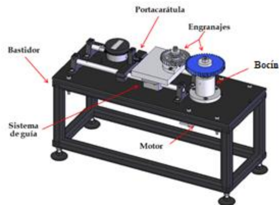
Figura 8. Diseño de concepto del banco para prueba de doble flanco. Fuente: [14].
