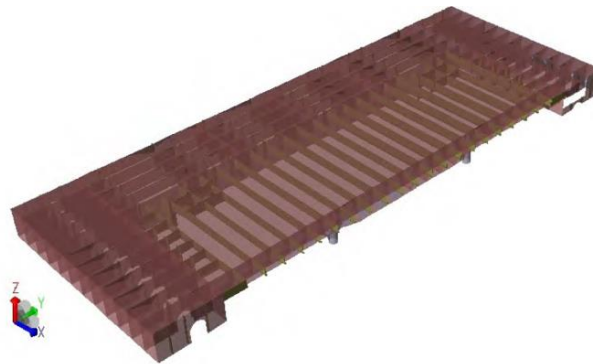
Figura 4. Modelo del MEF de la sección de la cubierta principal de un buque de apoyo a plataformas.
