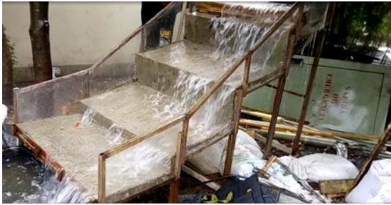
Figura 10. Régimen de flujo saltante en el modelo hidráulico de la estructura de caída con canal escalonado. Fuente: [10].
