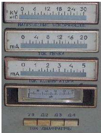
Figura 2. Panel con los indicadores de tres variables de explotación del GN.
