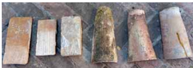
REPERTORIO DE PRODUCCIÓN LOCAL DE LOS TEJARES DE OSUNA Y COMARCA. DE IZQ., A DCHA.: LADRILLO DE RASILLA O ALFAJÍA PARA CUBIERTAS, LADRILLO MEDIANO PARA ALERO, Y DE TACO PARA LOS USOS MÁS HABITUALES; TEJA MORISCA, TEJA CAMBUJO Y TEJA CANAL CON LÁGRIMA O MANCHA VIDRIADA AL COCERSE LA PIEZA EN EL MISMO HORNO QUE CERÁMICA VIDRIADA. FOTOGRAFÍA: AMALIA TARÍN (2022).
