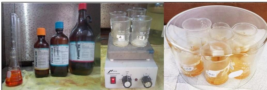
Figura 2. Proceso de digestión ácida de los filtros con contenido de partículas PM<sub>10</sub>.
