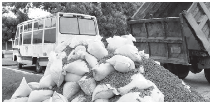
Figura 3. Depositando los RCD en la parte trasera del laboratorio de Ingeniería Civil del ITVH.
