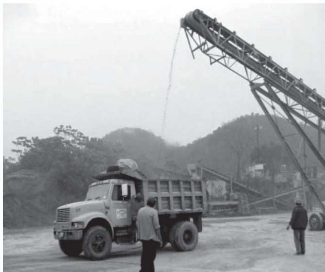
Figura 2. Trituración de el RCD en la empresa CATSA S.A. de C.V.
