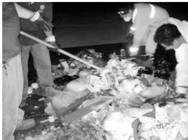
Figura 4. Homogenizado de los RSU.
