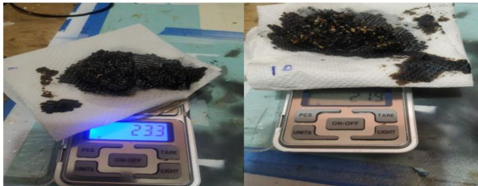
Fig. 4 - Determinación de la capacidad de absorción del olote en un derrame de petróleo.
