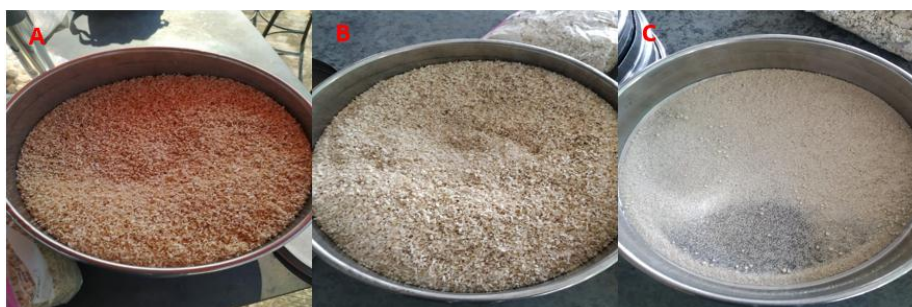
Fig. 1. Tamaño de partícula retenido en tamices: #16 (A), #30 (B) y #50 ©
