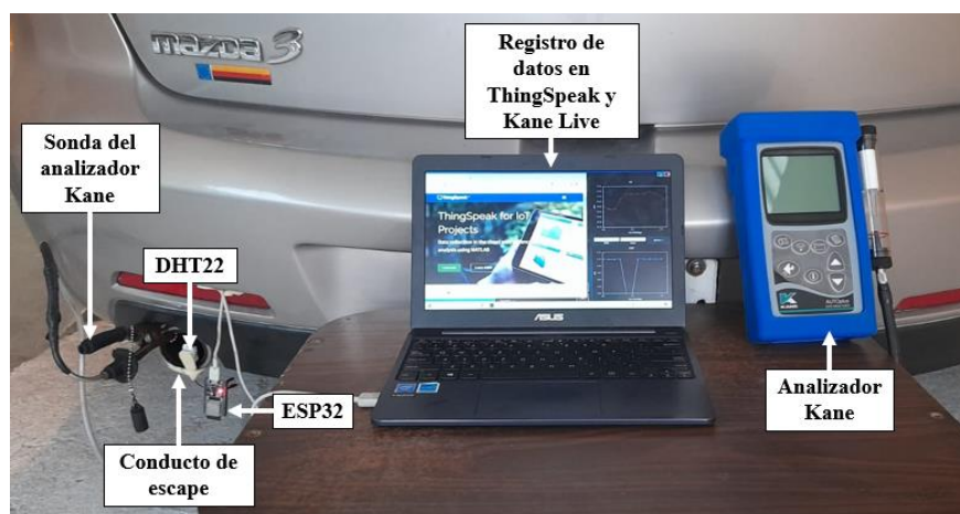
Figura 5: Instalación de elementos de medición en el vehículo
