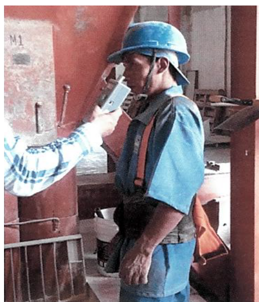
Figura 3. Medición de material particulado
