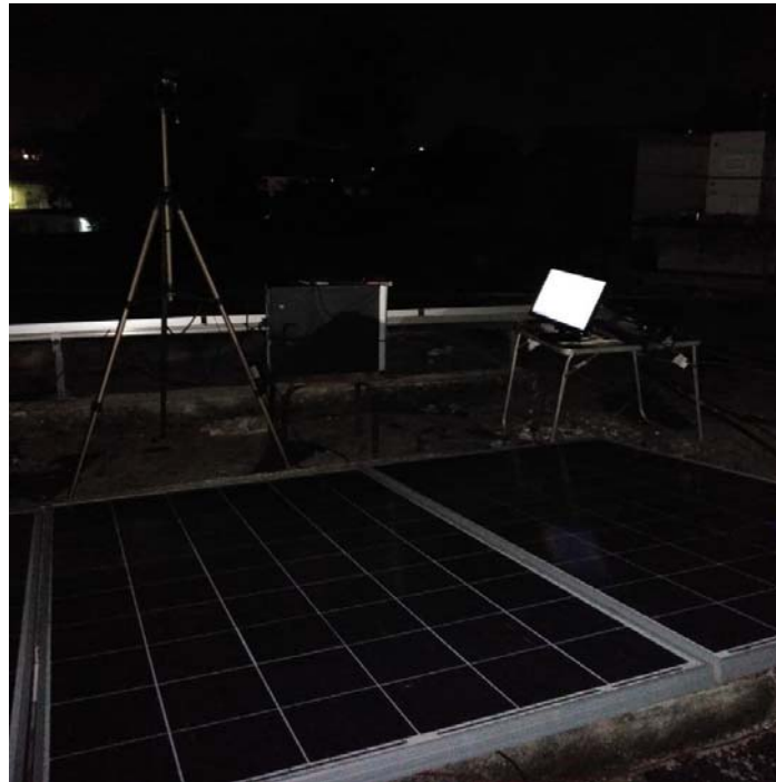
Fig. 3. Imagen real del set de medición sobre cubierta, para la realización de EL en horario nocturno.
