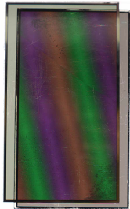
Fig. 5. Arianne Garrido, 2023. Efecto moaré derivado de la superposición de dos paneles LCD con angulaciones diferentes.
