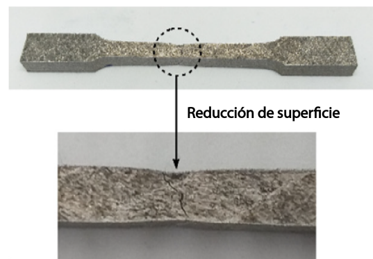
Figure 7. Reducción del área de la muestra utilizada en la prueba de tracción
