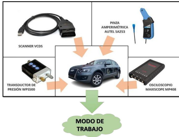
Ilustración 2: Instrumentos automotrices para detección del modo de trabajo
