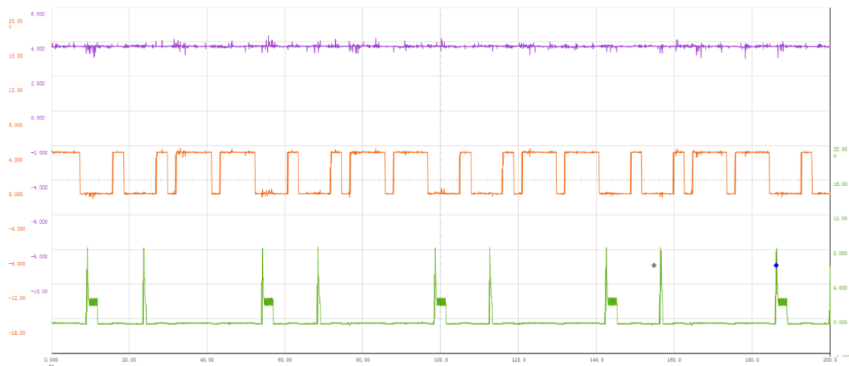
Ilustración 7: Oscilograma del sensor de la chapaleta, sensor CMP y la señal del inyector; cuando se encuentra a un \pm 60 el porcentaje del pedal del acelerador.
