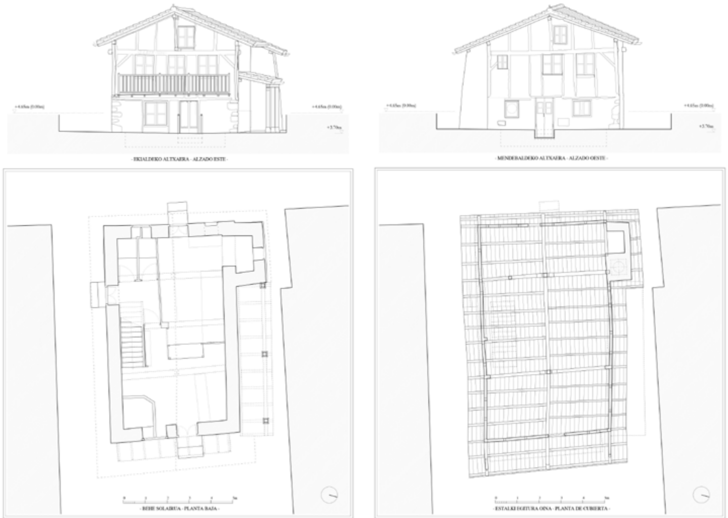
Figura 9: Levantamiento planimétrico del estado actual de la Casa Zerri. Planta baja con la fachada principal y planta primera con la fachada posterior.
