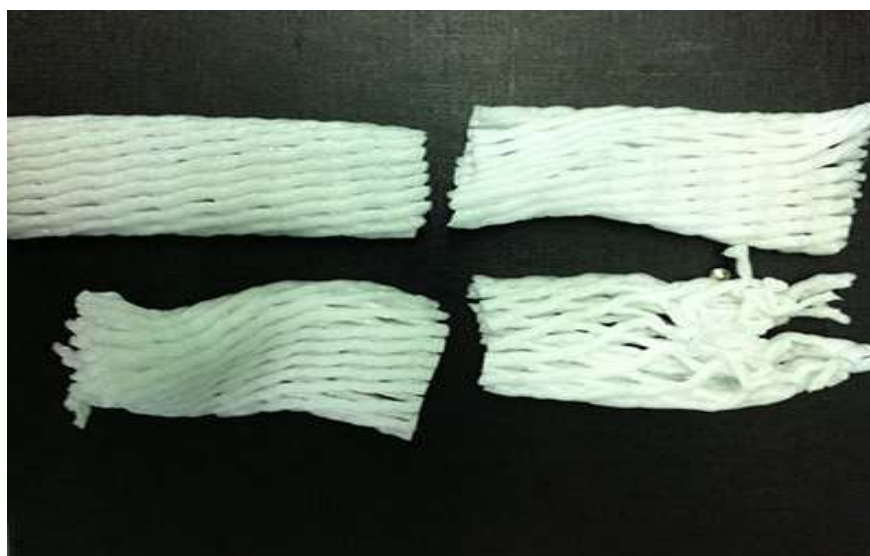
Figura 14: Produto Rede de PBD danificado.
