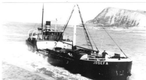
Figura 2 (primer barco con casco de acero y motor con motordisel )
