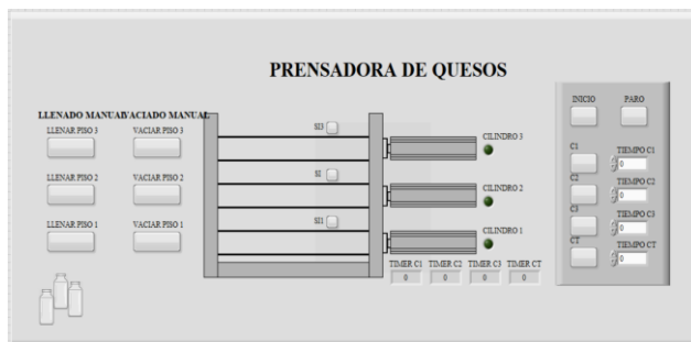
Figura 14. Interfaz de simulación de prensadora semiautomática. [Autores]
