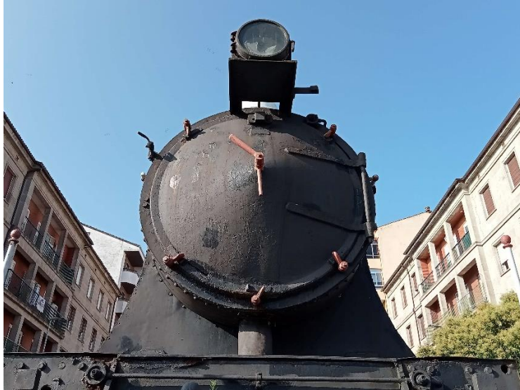
Figura 6: Vista frontal de la máquina. En primer término, puerta de acceso a la caja de humos . En la parte superior, farol de iluminación. Se aprecia a simple vista la extraordinaria calidad del timbre de la caldera (Fotografía del autor).
