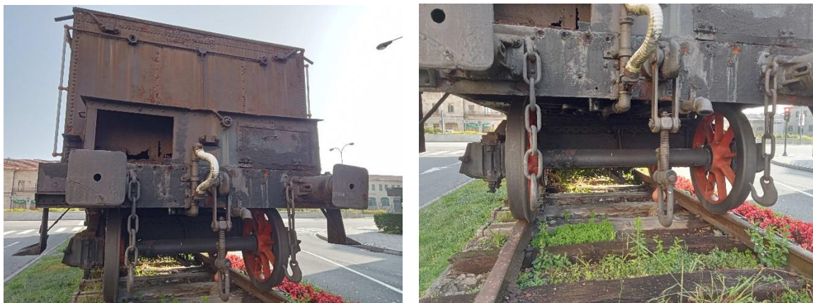
Figura 15: Vista general de la parte posterior del t nder (izquierda) y detalle de su sistema de enganche (cadenas y ganchos). Fotograf as del autor.
