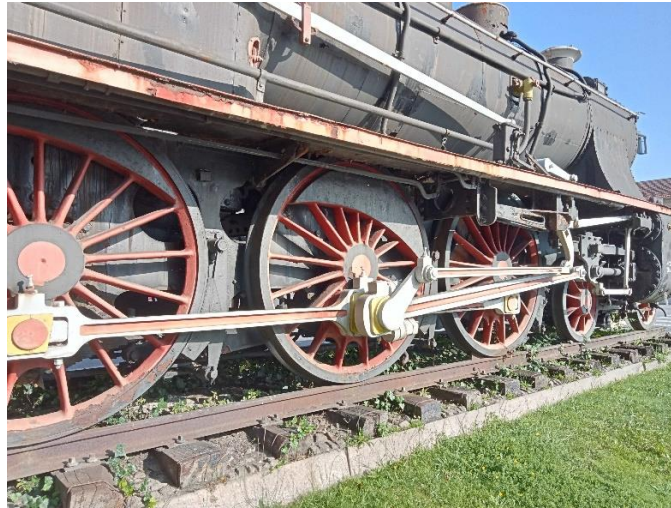
Figura 5: Detalle de las ruedas motoras, de gran diámetro. Destacan las barras de acoplamiento (para la conexión del sistema tractor) y los guardabarros, en forma de luna creciente en su parte superior (Fotografía del autor).
