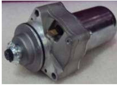
Figura 6. Motor de arranque utilizado en Castigador.
