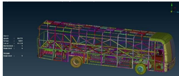
Figura 9: Mallado completo del autobús.
