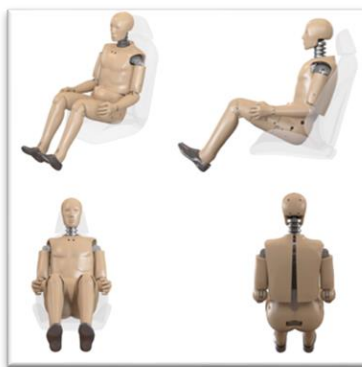
Figura 4: Dummy real híbrido III 50% percentil.
