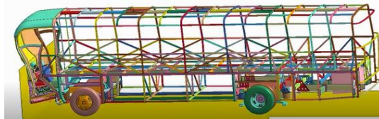
Figura 5: Impacto frontal de autobús método FEM. software LS-DYNA
