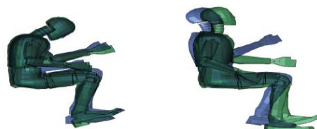
Figura 18: Comparación de maniqués, en azul maniquí en motor delantero, en verde con motor posterior, izquierda máxima energía cinética, derecha máximo cabeceo (rebote).
