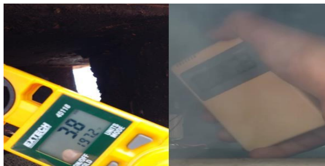
Fig.11. Instrumentos de medición, un Termo anemómetro y termohigrómetro [Fotografía], Investigadores, 2022.
