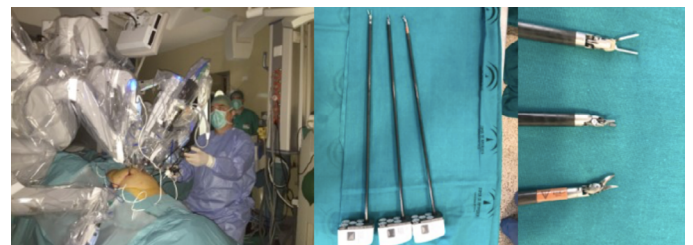
Figura 3 Brazos e instrumental del robot Da Vinci®.
