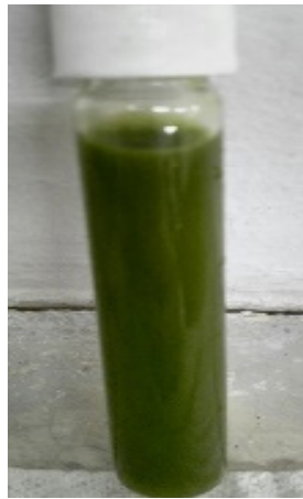
Fig. 6. Muestra de clorofila extraída utilizando etanol como solvente. Fuente: Autores.
