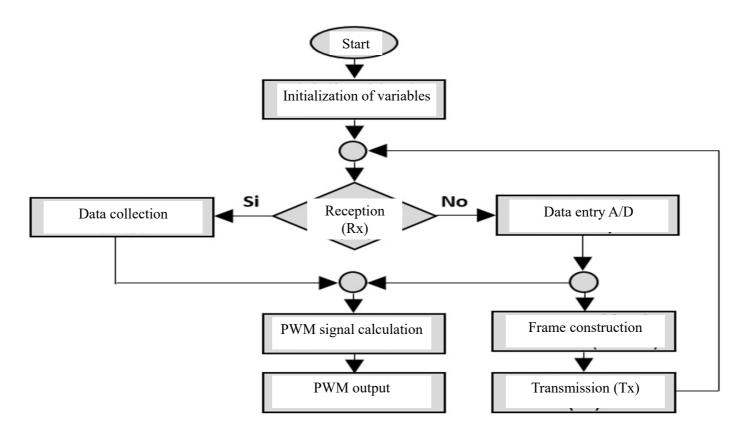
Fig. 4. Microcontroller Flow chart. Fuente: Elaboración propia.
