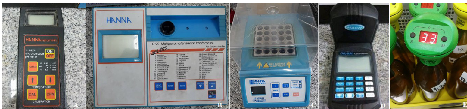
Fig. 2. Equipos utilizados para medir pH (A), DQO (B y C), sólidos suspendidos totales, nitrógeno y fósforo (D), DBO_{5,20} (E). Fuente: Autores.
