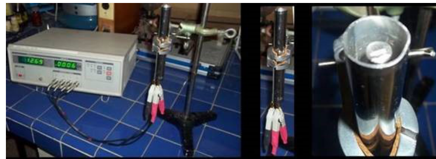
Fig. 1. Metro LCR y capacitor cilíndrico para las mediciones de \epsilon . Fuente: [2].
