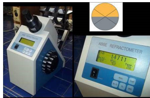
Fig. 2. Refractómetro de Abbe para la medición de n . Fuente: [2].
