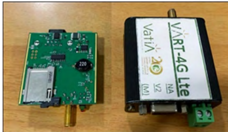
Figura 5. Visualización del PCB y equipo celular ensamblado en la caja.
