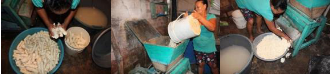
Figura 3 - Secuencia realizada en el proceso de rallado de la yuca y convertida en masa.
