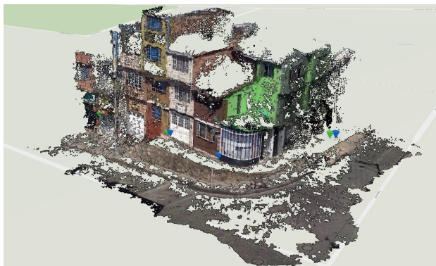
Figura 5. Representación de los puntos de control del suelo en la nube y contraste con los puntos evaluados del sistema de coordenadas IDECA.
