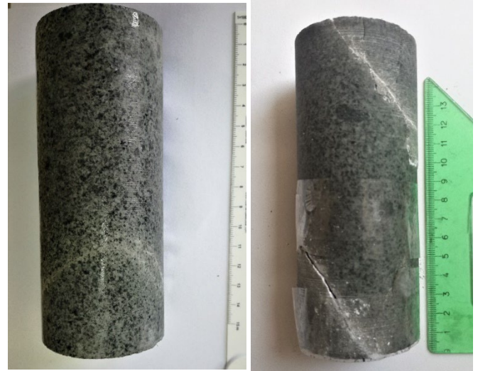
Figura 35. Núcleo de roca antes (intacto) y después del ensayo de compresión triaxial. Fuente: Los Autores
