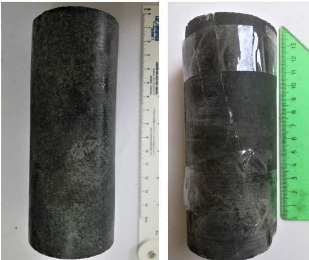
Figura 30. Núcleo de roca intacto y después del ensayo de compresión triaxial. Fuente: Los Autores
