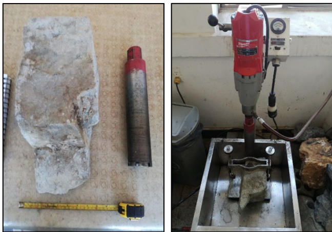
a) De un bloque de roca y broca de perforación tipo NX.
