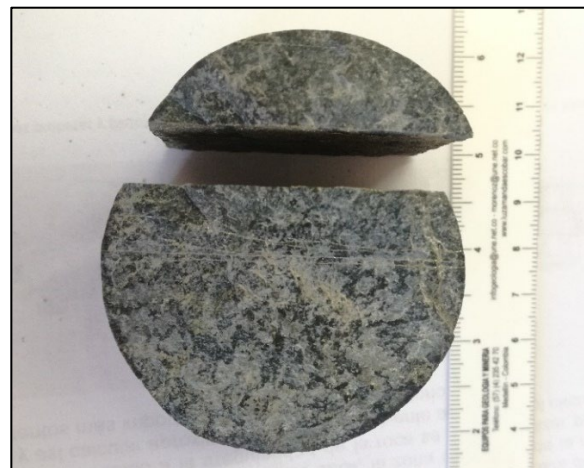
Figura 23. Modelos de falla ensayos diametrales. Fuente: Los Autores
