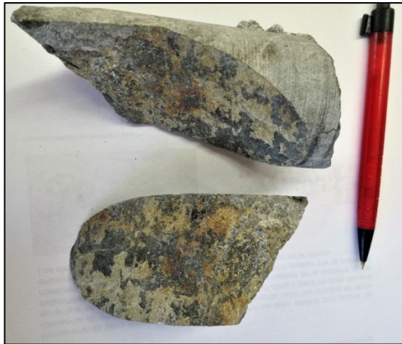
Figura 24. Modelos de falla ensayos diametrales. Fuente: Los Autores
