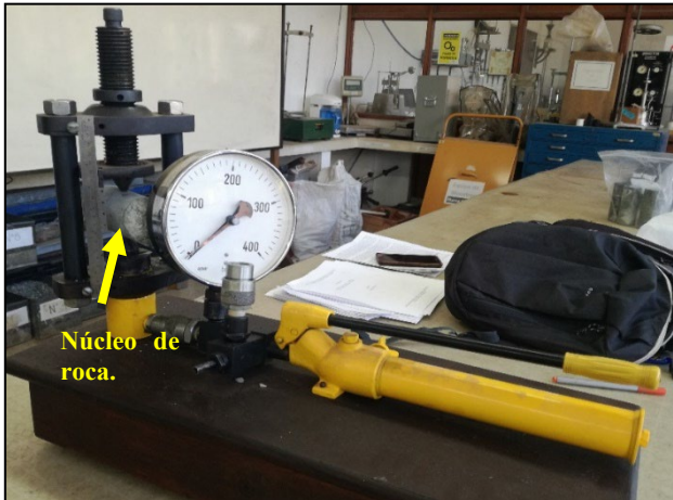
Figura 21. Sistema de carga tipo prensa Franklin para ensayos de carga puntual. Fuente: Los Autores.
