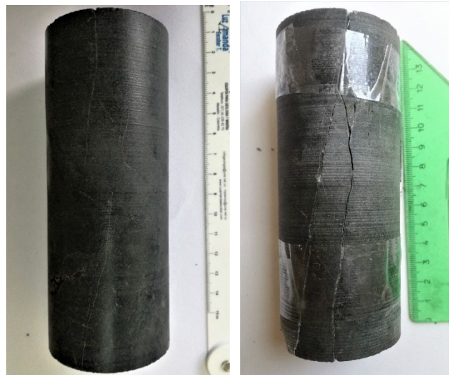
Figura 28. Núcleo de roca antes (intacto) y después del ensayo de compresión triaxial. Fuente: Los Autores
