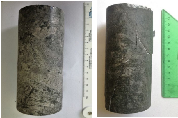
Figura 33. Núcleo de roca antes (intacto) y después del ensayo de compresión triaxial. Fuente: Los Autores
