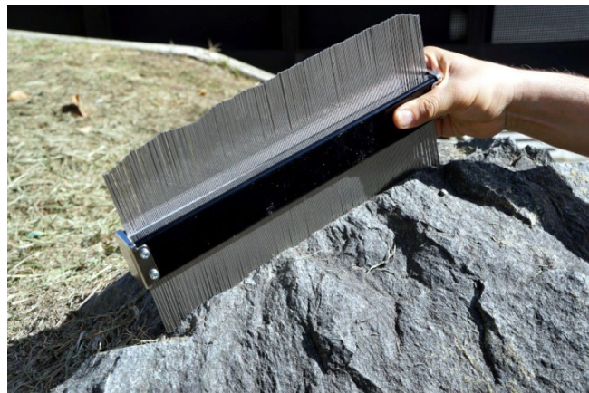
Figura 8. Uso del peine de Barton para la medida de la geometría de la ondulación de las discontinuidades. El peine de Barton es llamado así en la mecánica de rocas latina, al instrumento llamado duplicador de contorno, usado en carpintería. Fuente: Los autores.
