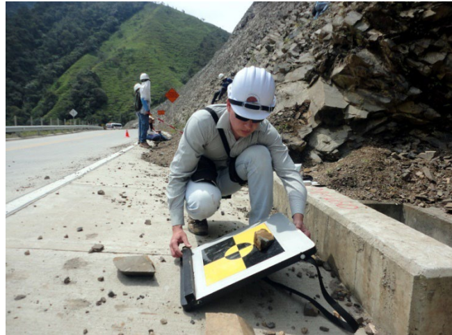
Figura 7. Ensayo en campo del ángulo de fricción básica con la mesa inclinada ( Tilt Test ) en el sitio de estudio. El ángulo de fricción básica \phi_b influye en la resistencia mecánica de las discontinuidades sin tomar en cuenta la ondulación, pero sí la aspereza. Fuente: Los autores.
